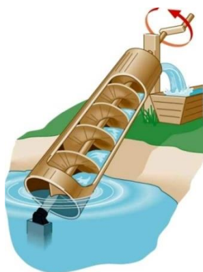
Figura 23. Funcionamiento tornillo de Arquímedes
