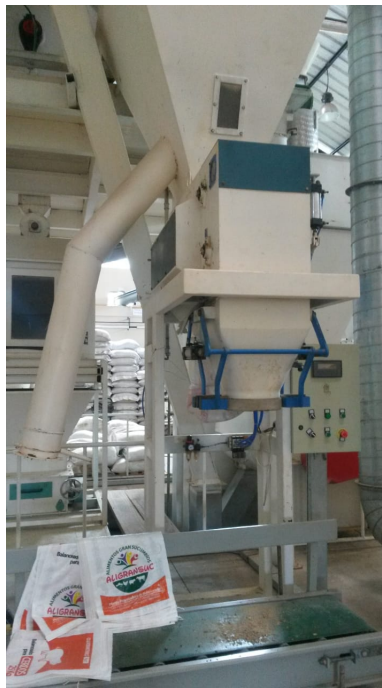
Figura 13. Proceso de ensacado por peso.
