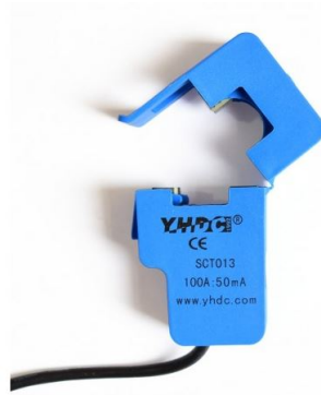
Figura 62. Sensor de Corriente No invasivo SCT-013-100.
