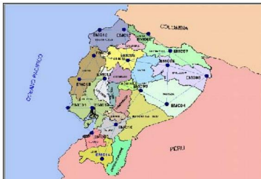
Figura 28. Red Ecuatoriana de Monitoreo Continuo (Satélite de Navegación en Tierra) Fuente: (Estrella, Diseño de la Red Ecuatoriana de Monitoreo Continuo REMC, 2003)
