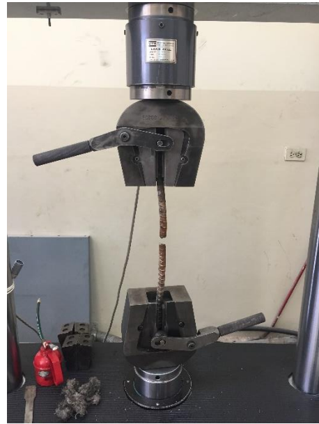
(b) Rotura de la varilla post ensayo
