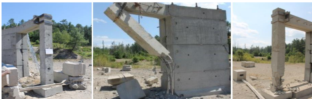
Figura 5. Ensayos destructivos realizados en elementos tipo Columna H.A. Fuente: (Siba, 2014)
