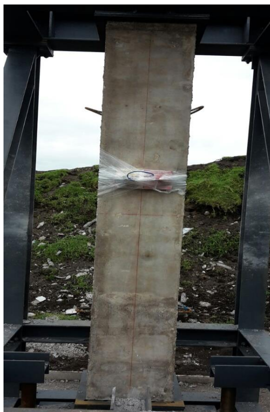
Figura 46. Colocación de las cargas a media altura en las probetas de hormigón armado tipo columna
