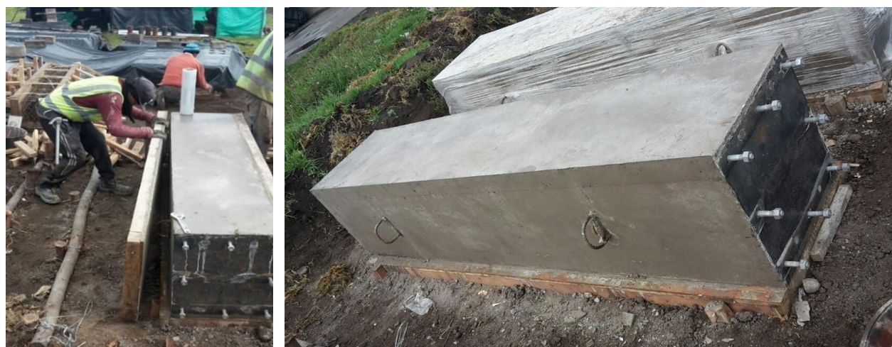
Figura 33. Desencofrado y curado de las probetas tipo columna de hormigón armado
