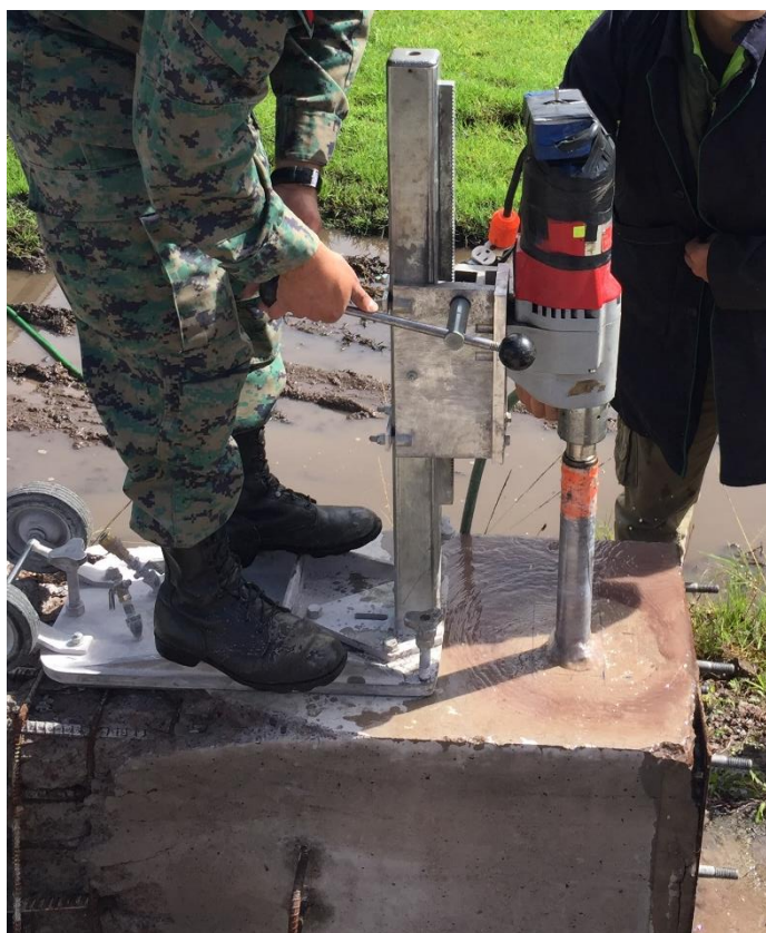
Figura 62. Máquina de extracción de núcleos en columna de 50 cm x 50 cm, f'_c 210kg/cm 2
