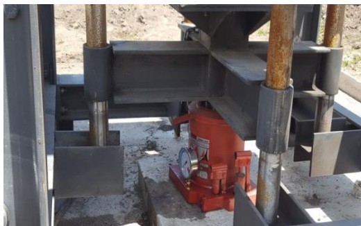
Figura 50. Ubicación del gato hidráulico
