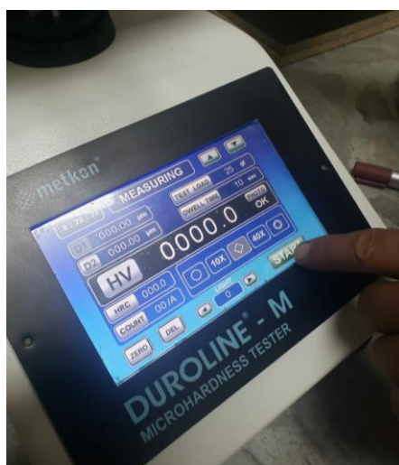
Figura 16. Calibración de la máquina para realizar ensayo de dureza.
