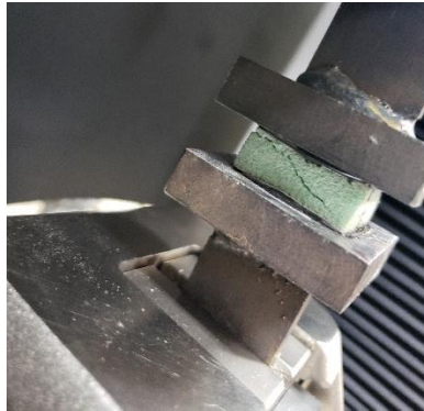
Figura 10. Probeta colocada en la máquina para ensayo de tracción plana y rotura por momento de torsión en la probeta.
