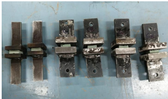
Figura 9. Accesorios y probeta para ejecutar ensayos de tracción plana
