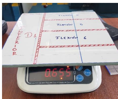
Figura 21. Probeta colocada en la balanza digital.
