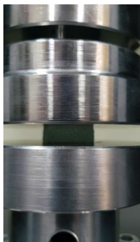
Figura 19. Probeta colocada para ensayo de compresión.
