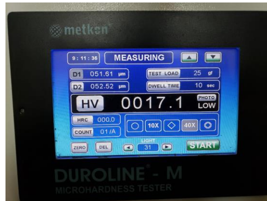
Figura 18. Ejemplo de datos que entrega la máquina en ensayos de dureza.
