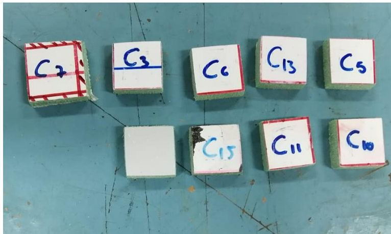
Figura 5. Probetas para ensayo de tracción plana
