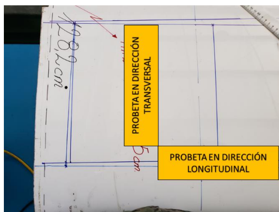
Figura 15. Ejemplo de corte de probetas para ensayo de flexión
