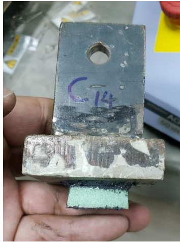
Figura 12. Probeta despegada de su acople.
