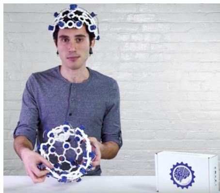
Figura 15. EEG de OpenBCI Fuente: (OpenBCI, 2019)
