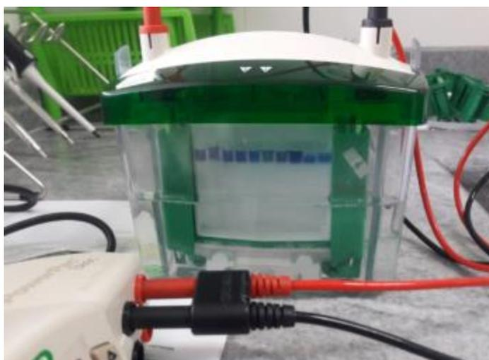
**Figura 22** Electroforesis vertical mediante el sistema Mini-PROTEAN Tetra Cell de Bio-Rad
