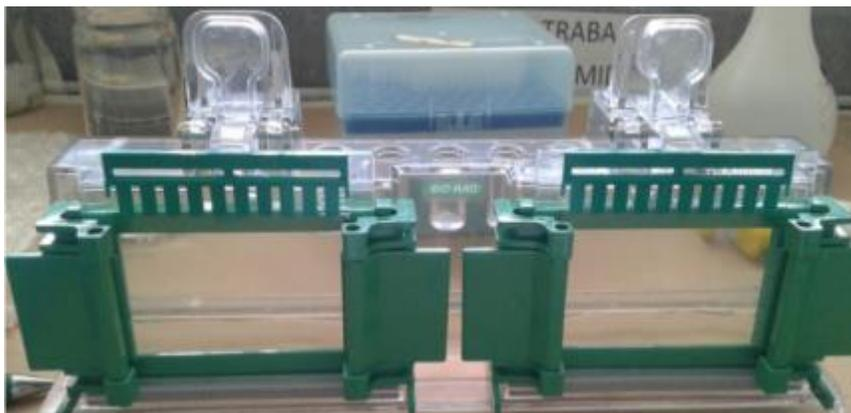
**Figura 21** Preparación de geles de poliacrilamida en el soporte *gel casting* de Bio-Rad
