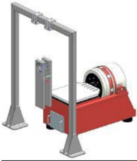
Figura 11. Montaje para marco y placas.
