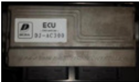
Figura 7. Unidad electrónica de control. [1]
