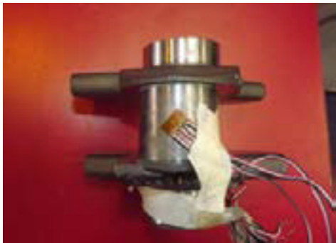
Figura 8. Cigüeñal instrumentado con roseta de deformación.
