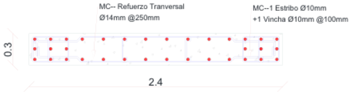
Figura 4.8. Armado del muro estructural. Elaboración: Criollo, Stalin, 2018
