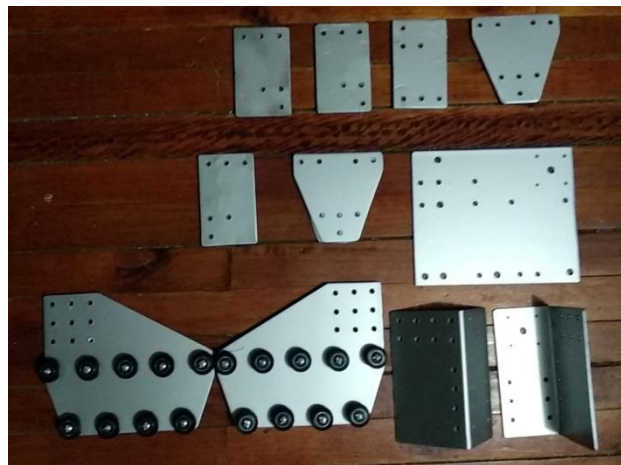
Figura 83 Placas de aluminio para ensamblado de la estructura de la plataforma robótica
