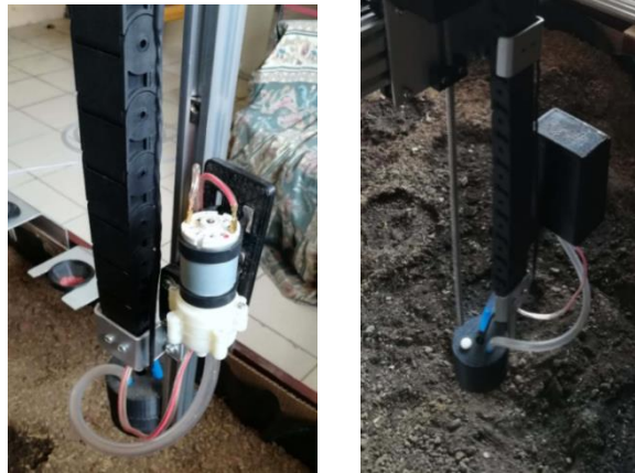
Figura 91 Montaje de la Bomba de Vacío en el Eje
