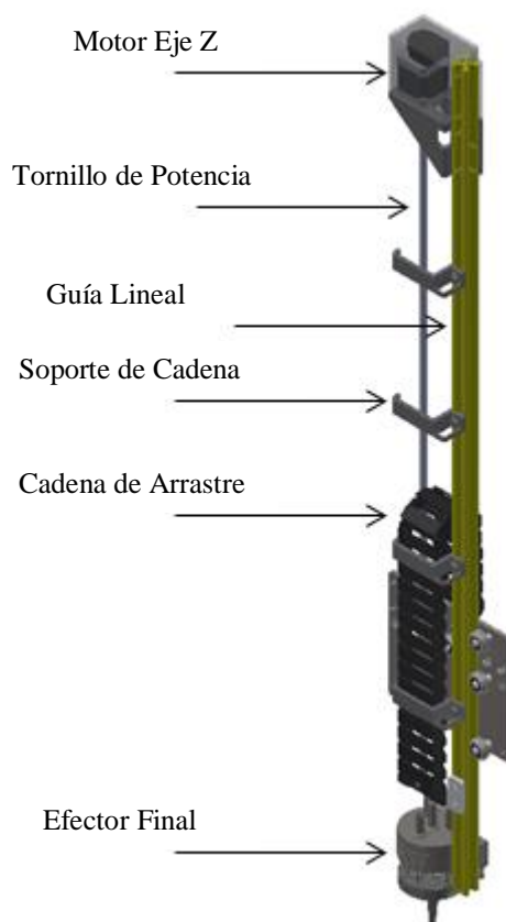
Figura 24 Componentes que actúan en la Guía del Eje Z
