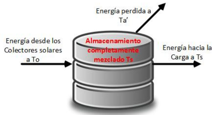
Figura 10. Modelo de tanque de almacenamiento ideal (No estratificado).
