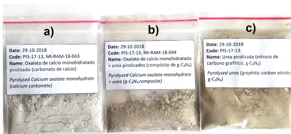
Figura 6. Muestras de: a) oxalato de calcio monohidratado pirolizado ( \text{CaCO}_3 ), b) compósito de \text{g-C}_3\text{N}_4 , c) urea pirolizada ( \text{g-C}_3\text{N}_4 )
