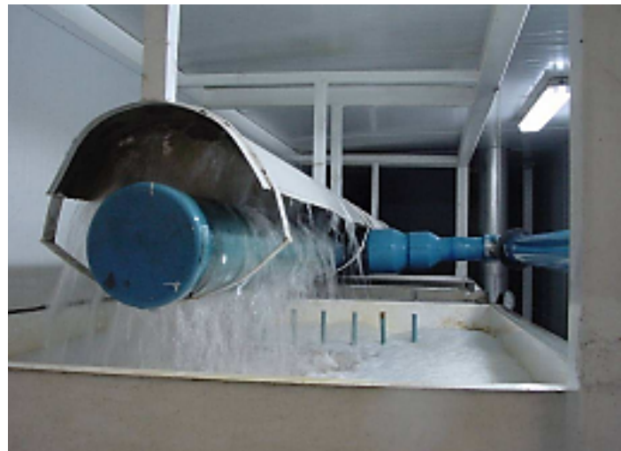
Figura 12. Sistema de Hidro enfriado, Revistadigital INESEM (2012).
