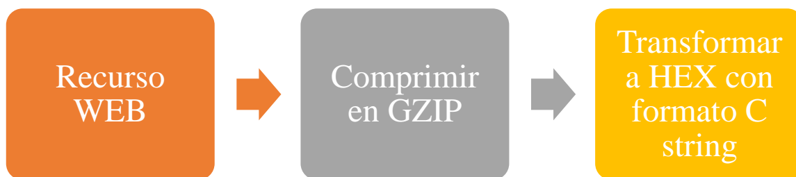
Figura 74. Proceso de compresión de recursos de Servidor Embebido
