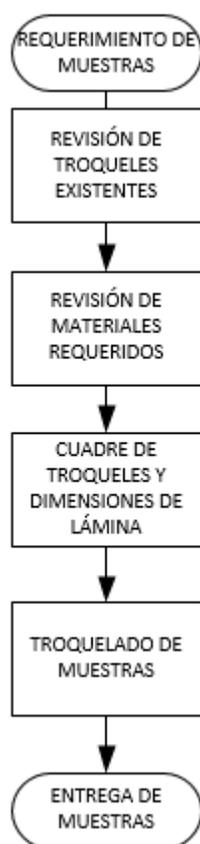
*Figura 12.* Proceso estimado para la realización de muestras
