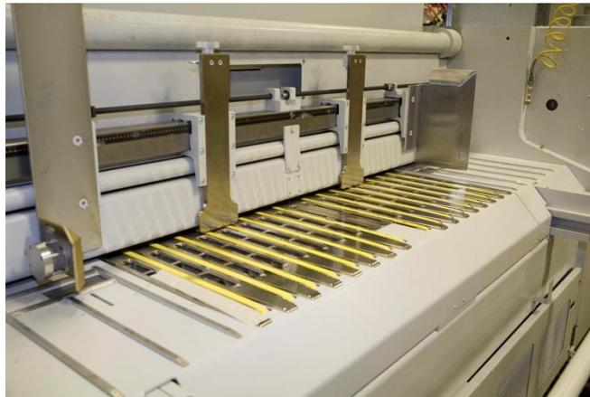
*Figura 22.* Sistema de alimentación troqueladora WARD.
