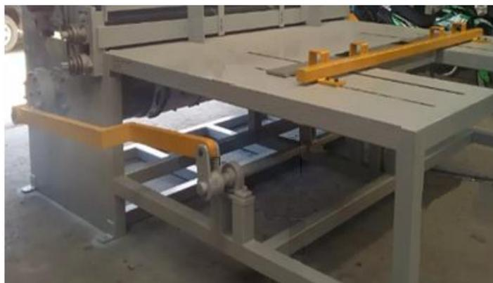
**Figura 23.** Mecanismo Mecánico de alimentación tipo "patada".
