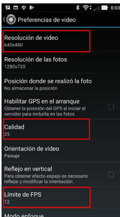
Figura 31. Configuración de parámetros de video
