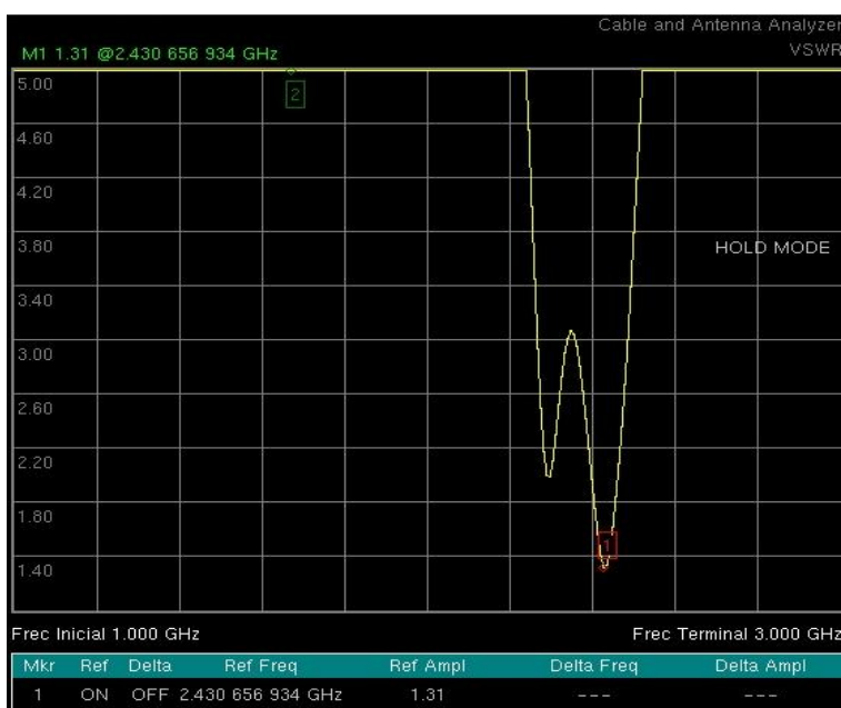
Figura 40. VSWR de antena parche rectangular de 1 elemento.
