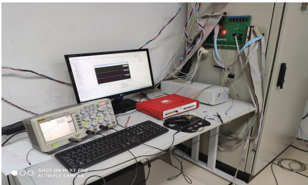
Figura 37. Conexión física del Typhoon HIL con la dSPACE
