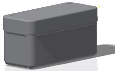
Figura 44. Caja de acero utilizada para la fabricación de las 5 cámaras de sensado.
