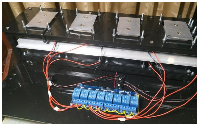
Figura 52. Acople de las celdas Peltier en la plataforma de sensado.
