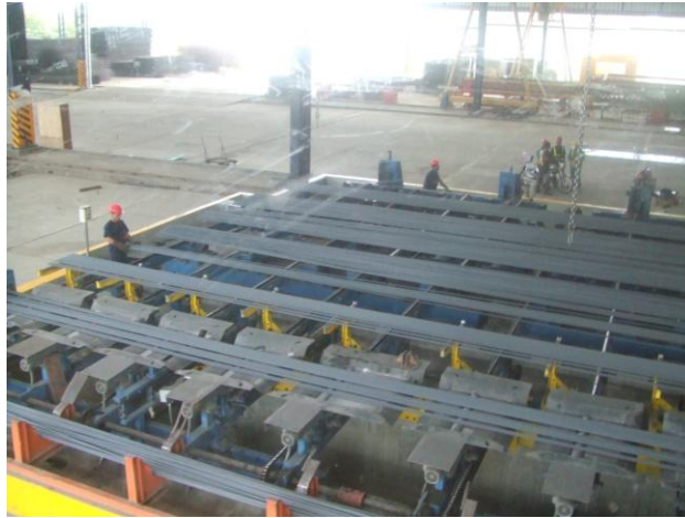
Figura 2.18 Operador contando varillas
