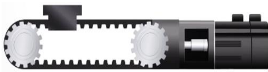
Figura 36. Transmisión de movimiento lineal mediante banda dentada.
