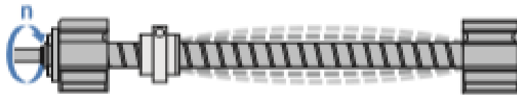
Figura 87. Comportamiento del tornillo a velocidad crítica.
