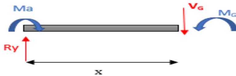
Figura 96. Método de cortes para encontrar el momento flector.
