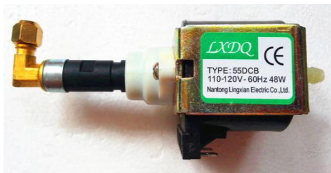
Figura 45. Bomba utilizada para la succión de pintura.
