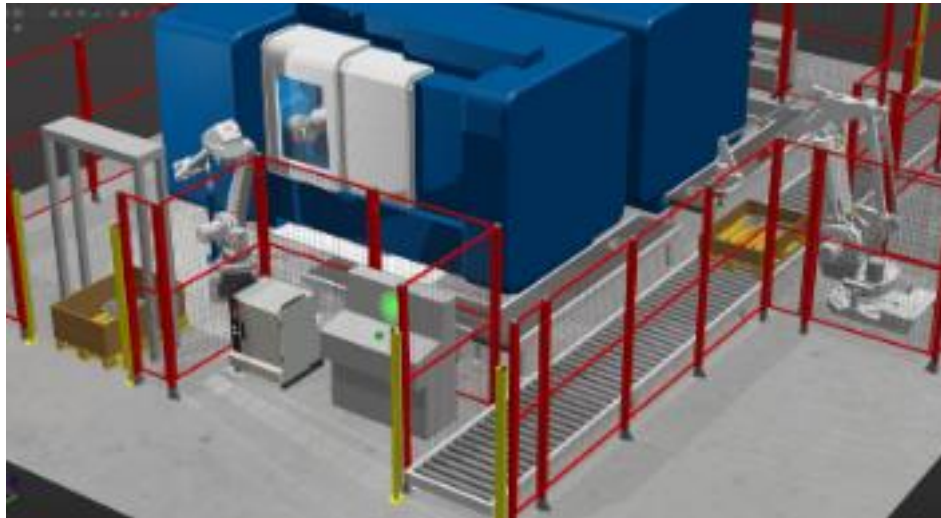
Figura 29. Celda robotizada simulada en el software de ABB Robot Studio.
