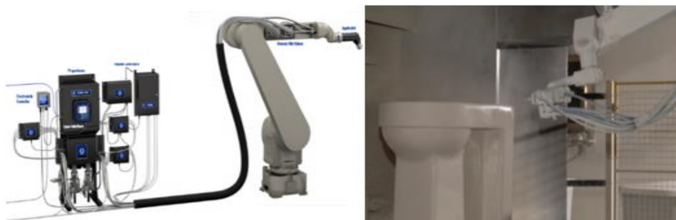
Figura 26. Comparación de robots de pintura con muñecas huecas y sólida.
