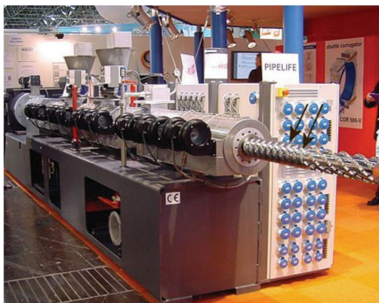
Figura 37. Extrusora monohusillo DREX 120-55 para compounding de Ropllepaal.
