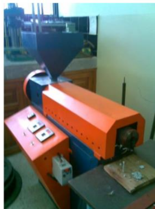
Figura 63. Máquina extrusora del laboratorio de Mecánica de Materiales del DECEM. Fuente: ([Capítulo 2. Marco Teórico. Proceso de extrusión de plásticos], s. f.).
