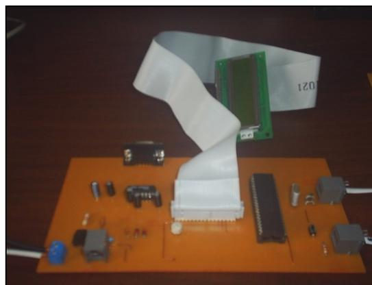
Figura. 3.6. Implementación en Placa de Circuito Impreso del Sistema de Adquisición de Datos y Control
