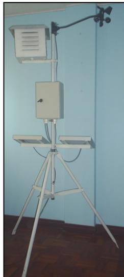
**Figura. 3.19. Implementación en la Estructura de la Garita Meteorológica**
