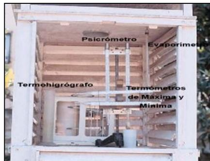
**Figura. 2.2. Termómetros y Psicrómetro**
