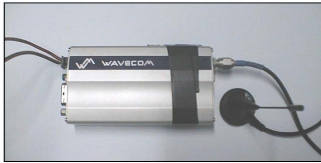
**Figura. A.5. MODEM GSM Modelo WM02 G900**
