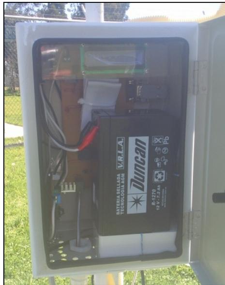
**Figura. 3.8. Implementación del Sistema de Adquisición de Datos y Control en la Caja**
