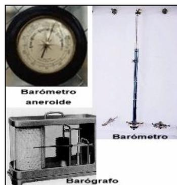
Figura. 2.1. Barómetro, Barógrafo
