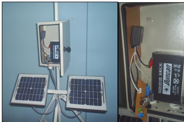
Figura. 3.23. Implementación en Placa de Circuito Impreso del Subsistema de Alimentación Solar Autónomo
