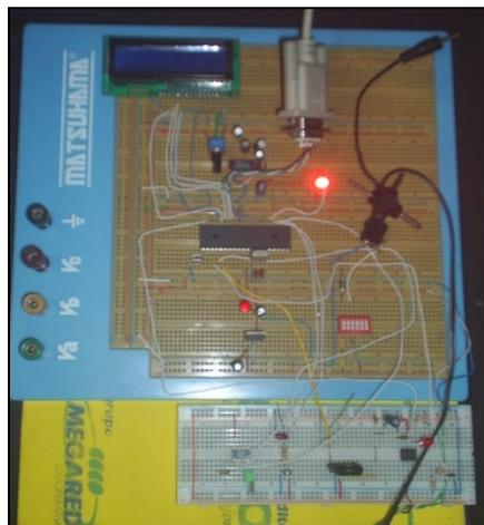
Figura.5.5. Conexiones del Subsistema de Sensores
