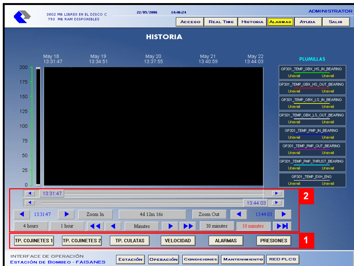
Figura 5.8. Pantalla Historia del HMI
