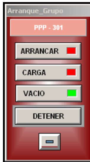
Figura 5.11. Menú Control del grupo P – 301 de la aplicación HMI
