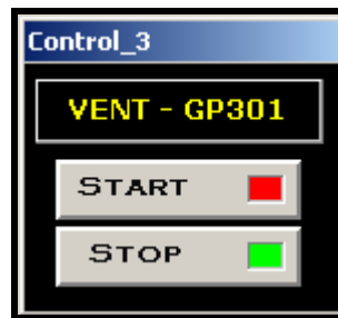
Figura 5.12. Menú control del ventilador del radiador del grupo P – 301
