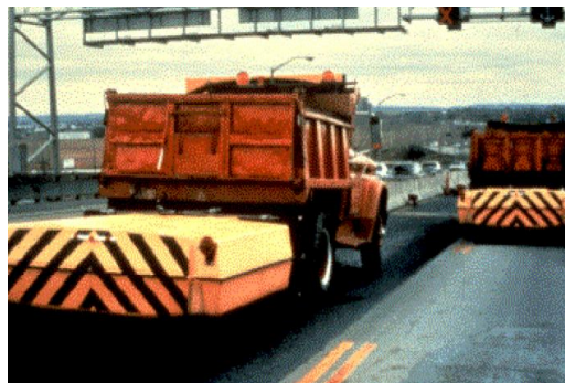
Figura 8. Amortiguador de impacto móvil sobre camión.
