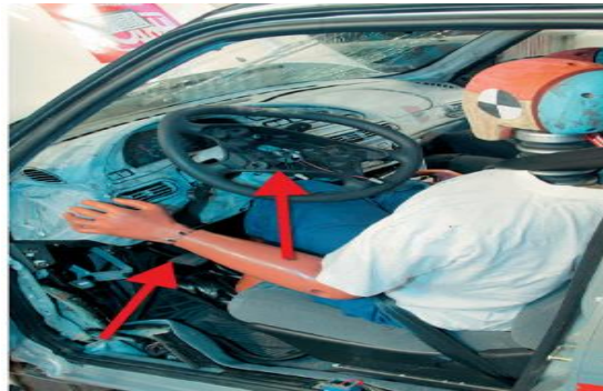
Figura 23. En caso de impacto frontal, el volante y pedales deben desplazarse para no dañar al conductor
