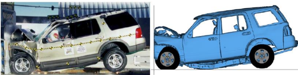
Figura 48. Comparación de la prueba FEM vs. ensayo NCAP
