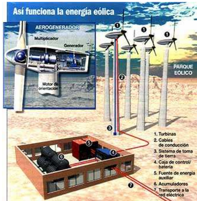
Figura. 1.1. Generadores de Energía Eólica
