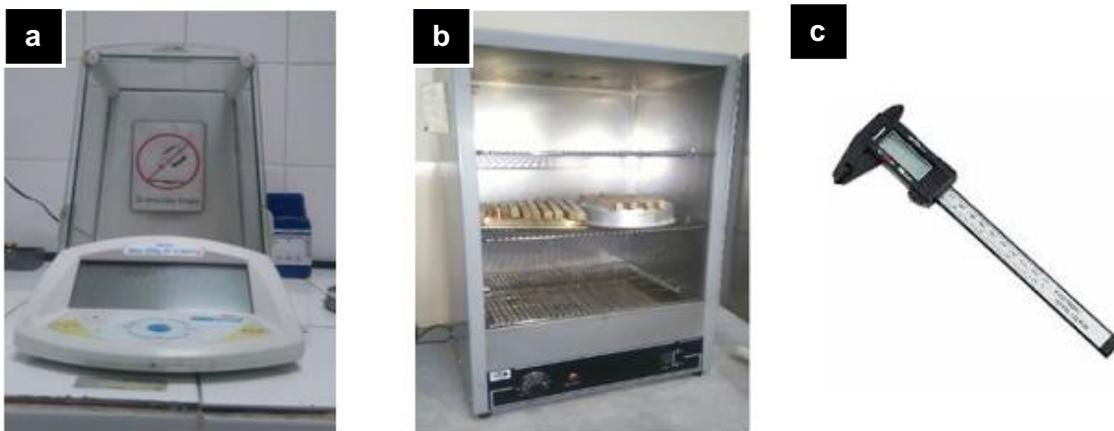
*Nota:* (a) Balanza electrónica, (b) horno para secado de muestras y (c) calibrador electrónico de 0,01 mm de precisión.
