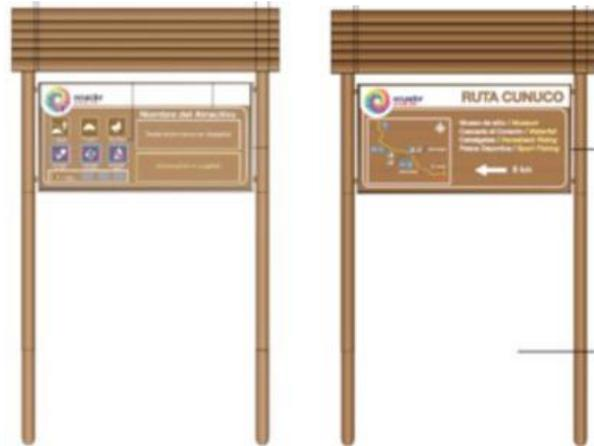
**Materiales** Sustrato: Madera de Teca. Se puede utilizar madera de árboles caídos del propio Bosque si se deseara. La madera debe estar inmunizada con 40 mm de espesor.
