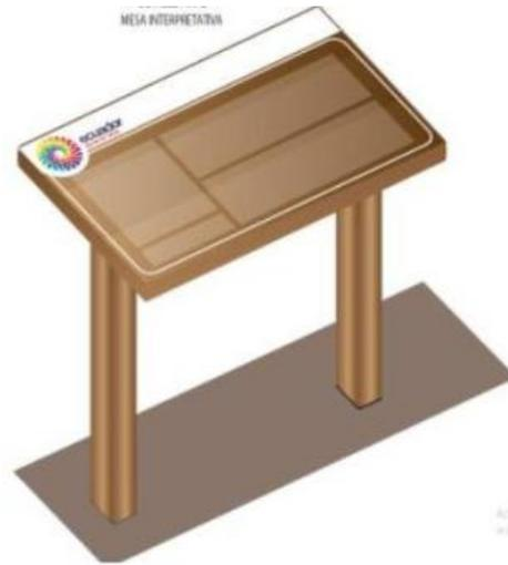
**Materiales** Pantalla: Madera tallada y pictograma de material retroreflexivo. El grosor de las planchas debe ser de 500 mm
