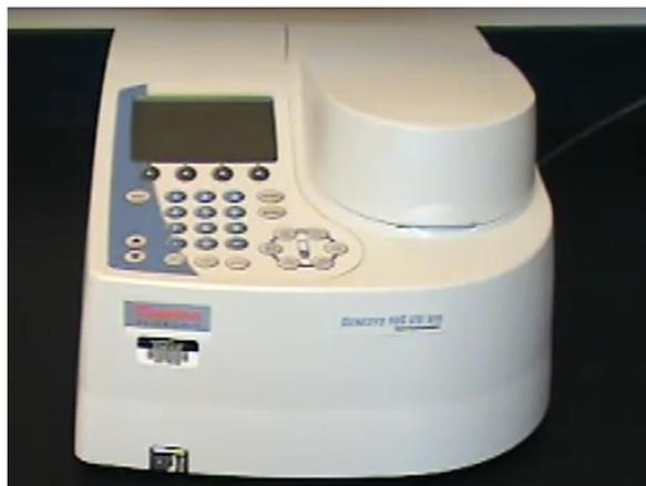
**Figura 18.** Espectrofotómetro Genesys Mod. 10S
