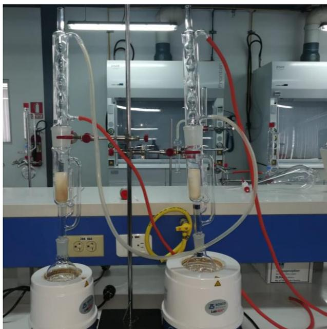
**Figura 12.** Equipo de extracción Soxhlet.
