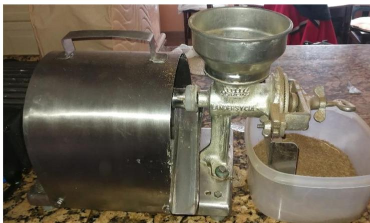
**Figura 11.** Molienda del pseudotallo seco con un molino semi-industrial
