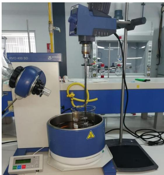
**Figura 13.** Equipo para hidrólisis ácida.
