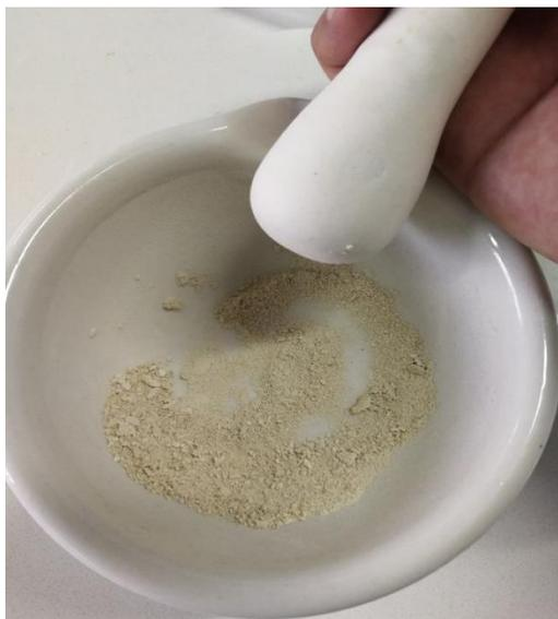
**Figura 16.** Celulosa obtenida al final de los procesos de hidrólisis ácida y tratamiento básico.
