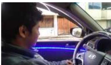
Figura 52. Activación de luz LED azul al detectar bostezo
