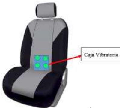
Figura 43. Ubicación de la caja vibratoria en el asiento del conductor
