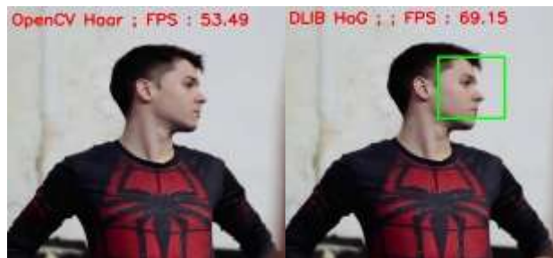
Figura 22. Comparación entre el clasificador Haarcascade y HOG
