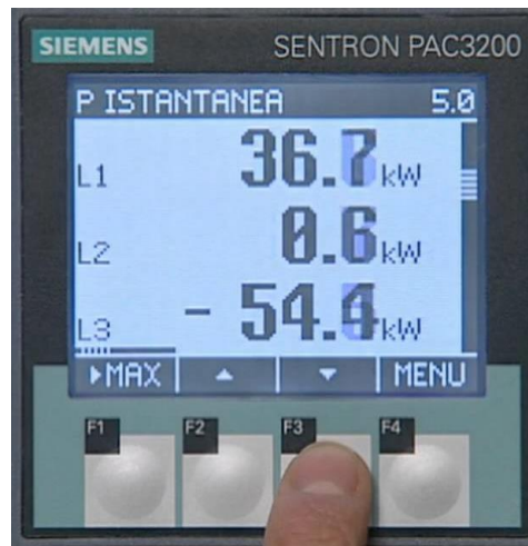
Figura 53. Configuración desde el panel del medidor de energía.
