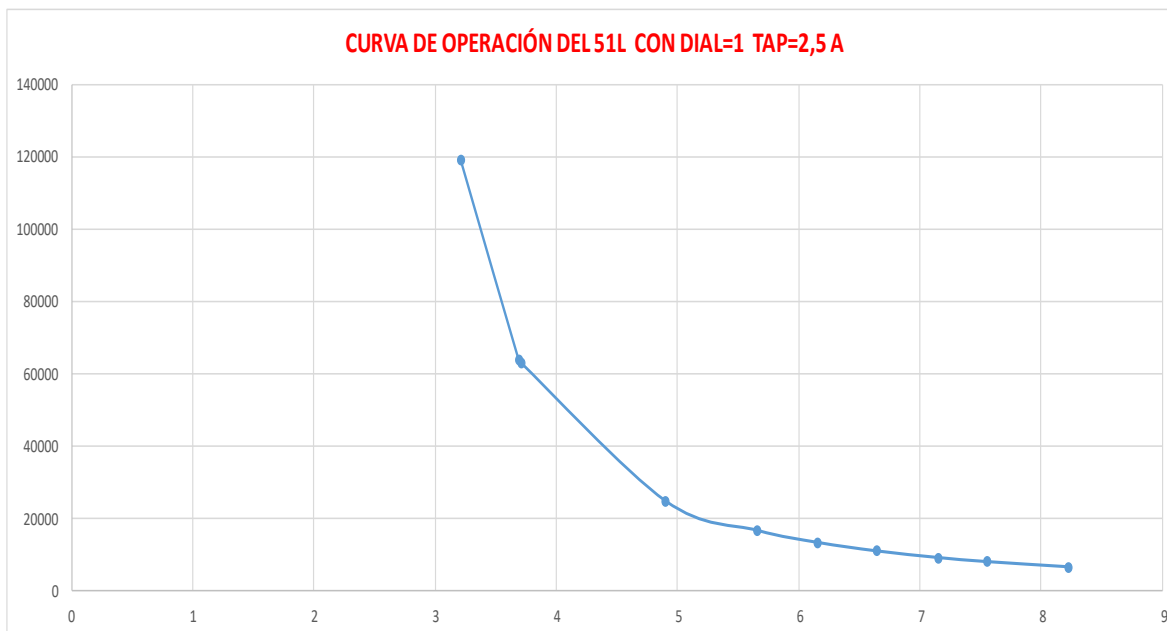
Figura 57. Curva de operación del relé 51L con datos del módulo
