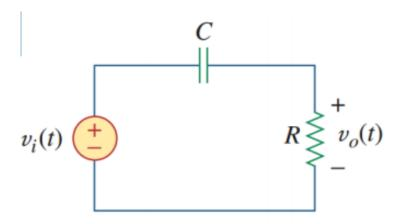
Nota: la figura 17 muestra un circuito básico de primer orden. Tomado de (SÍNTESIS DE FILTROS PASIVOS, 2004)
