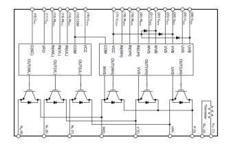
Para el acondicionamiento de la etapa de potencia se utilizó el catalogo que nos recomienda el fabricante, con cada uno de los elementos y valores ya calculados anteriormente, se utilizan fuentes de 5V, 15V aisladas de la etapa de control, la alimentación para el motor es de 120 V.
