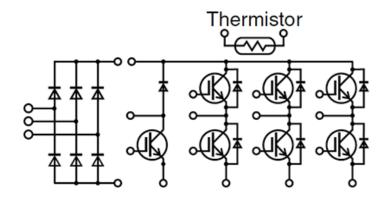
Nota: Existen módulos que cuentan con un IGBT adicional para el disparo y así generar el frenado dinámico del motor. Tomado de (fujielectric, 2020)
