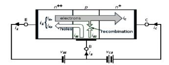
Nota: la unión de un transistor puede ser de tipo NPN Y PNP. Tomado de (Yang, 2018).
