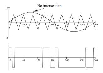
Nota: el índice de sobre modulación permite obtener la magnitud de voltaje Ac a la salida del inversor. Tomado de (ijcem, 2016)
