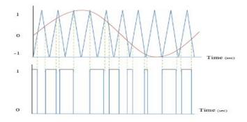
Nota: este diagrama se utiliza para representar la adquisición de la señal PWM mediante la comparación de dos señales. Tomado de (MOHD NAJIB BIN HUSSIN, 2014).
