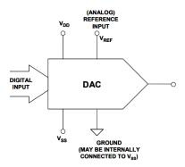
Nota: circuito muestra como es el proceso para llevar una señal digital a una señal analógica. Tomado de (Texas instrument, 2008)
