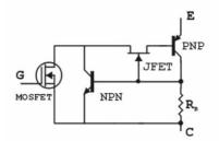
Nota: un dispositivo igbt está conformado por un arreglo de transistores. Tomado de (MOHD NAJIB BIN HUSSIN, 2014)
