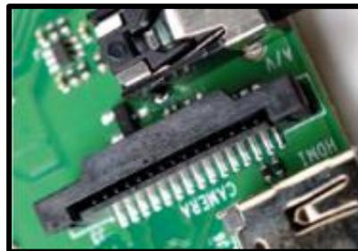
**Nota:** Permite la conexión de una cámara especial diseñada para la Raspberry (Halfacree, 2018)
