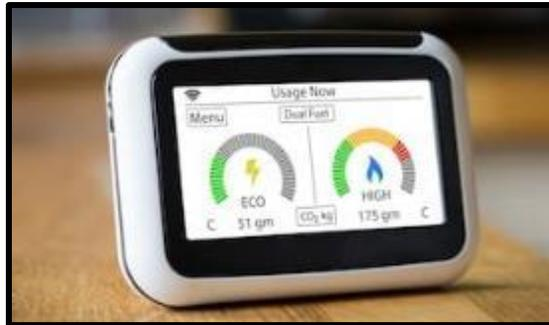
**Nota:** En la figura se indica un medidor electrónico inteligente (Antb, 2020)
