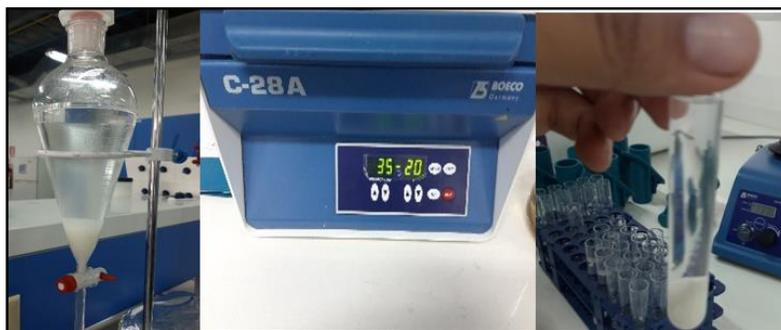
*Nota.* El gráfico representa el proceso de centrifugación de nanocelulosa.
