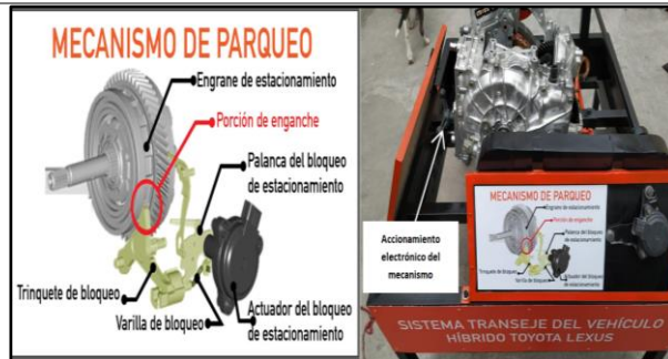
Despiece del mecanismo de parqueo
