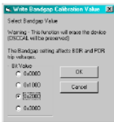
Figura. 3.13. Valor del bit de selección del bandgap
