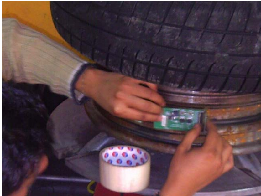
Figura. 4.1. Colocación del sensor-transmisor en el rin del neumático
