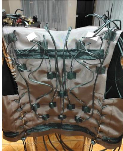
Una vez ubicados los actuadores y realizado el cableado respectivo, se utilizó una malla plástica para cubrir el cableado electrónico y proteger a los actuadores vibrotáctiles en todo el chaleco, dándole además una personalización más estética.
