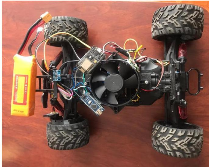
**Sistema Electrónico para Control de Acciones.** Este sistema tiene como propósito el manejo de los componentes mecánicos orientado al desplazamiento del vehículo, el cual ejecuta tareas tales como el control de la dirección y variación de velocidad.
