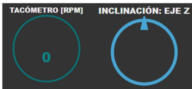
El tacómetro recibe los valores obtenidos del grado de presión que se ejerce en los pedales, siendo el valor mínimo 0 cuando no existe presión y 8 cuando la presión ejercida es la máxima. El valor es recibido por el puerto serial correspondiente del volante al computador.
