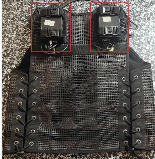
En la Figura 68 se muestra la ubicación de la batería lipo encargada de la alimentación del sistema electrónico.
