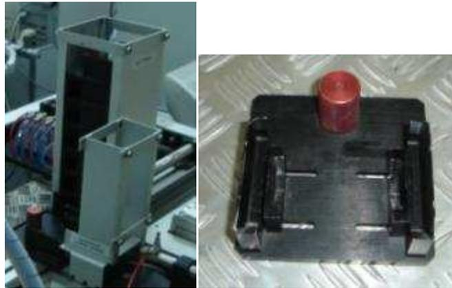
Figura. 2.5. Almacén de pallets y pallet
