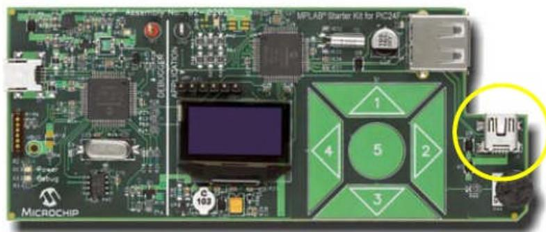
Figura. 2.23. El puerto USB mini B receptor en la tarjeta Starter kit PIC24F
