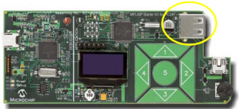
Figura 2.22. El puerto USB tipo A receptor en la tarjeta Starter kit PIC24F
