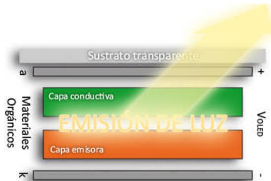
Figura. 2.14. Esquema de un foco OLED
