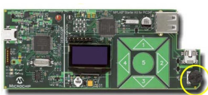
Figura. 2.17. El potenciómetro en el Starter kit PIC24F
