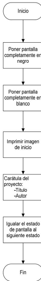
**Figura. 3.20. Flujo de la función ProbarTarjeta()**
