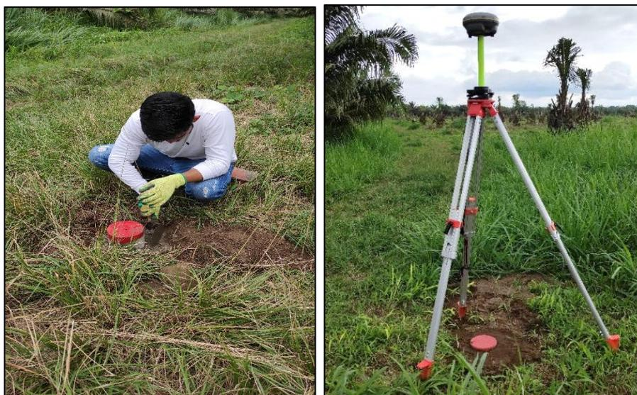
*Nota:* La figura indica el hito y el equipo utilizado en el posicionamiento de los puntos de control terrestre.
