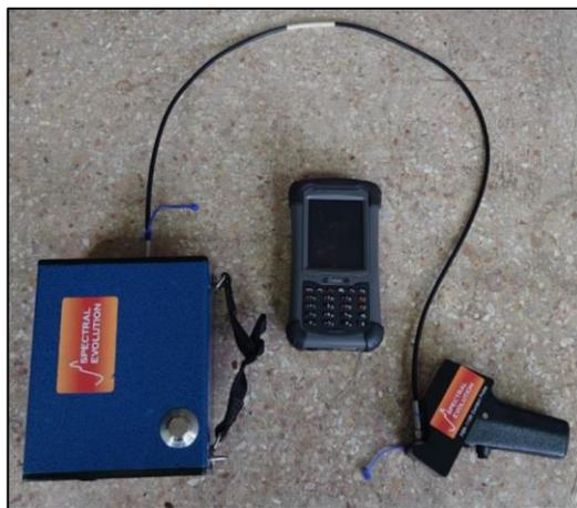
*Nota:* La figura indica el espectroradiómetro utilizado.
