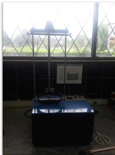
*Nota: Agitador mecánico usado para tamizar las muestras.*
