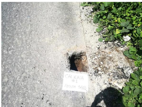
El Ministerio de Transportes Obras Públicas de Santo Domingo (MTOP – SD) supo informar los espesores de las capas de pavimento colocados en el tramo de la vía de estudio y al realizar una caracterización en campo de las distintas capas de la estructura del pavimento existente, se verificó los distintos espesores, teniendo como resultado los planteados a continuación:
