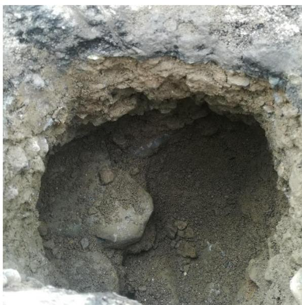
*Nota: Calicata en zona de estudio, se puede apreciar el material granular del que está compuesta.*
