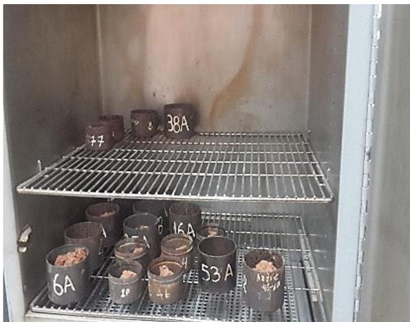
*Nota: Cápsulas dentro del horno a temperatura constante.*
