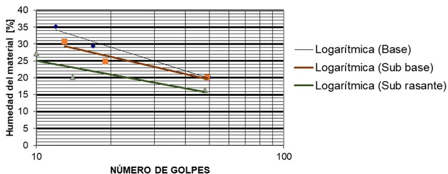
Nota: Curvas logarítmicas de las capas de la estructura de pavimento.
