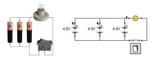
Nota: la ilustración muestra la forma en que está conectado el circuito en paralelo con todos sus elementos. (Galicia, 2014)
