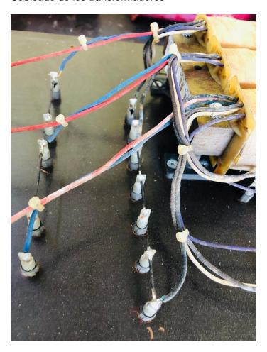
Se procede a hacer el Megado de bobina, limpieza de la tarjeta, luego el Megado y el embarnizado.
