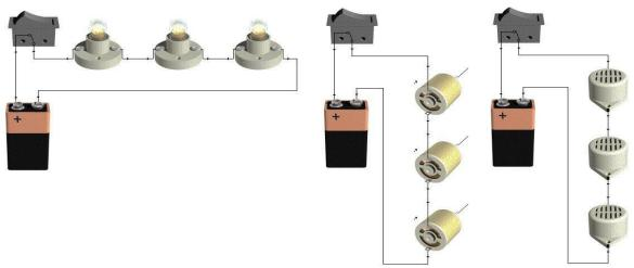
Nota: la ilustración muestra la forma en que está conectada el circuito en serie con todos sus elementos. (Galicia, 2014)
