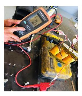
Se realiza la medición del bobinado para comprobar su funcionalidad y determinar el estado en el que se encuentran.
