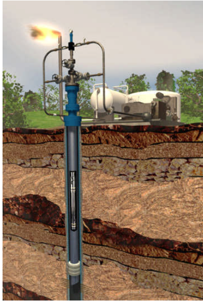
Figura 2.1 Esquema Sistema de Bombeo Hidráulico
