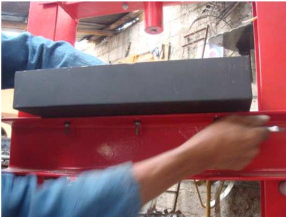
**Desmontaje del Molde inferior**
