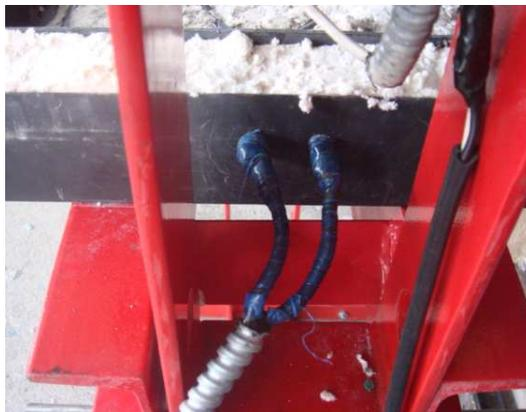
**Conexión eléctrica de la resistencia inferior**
