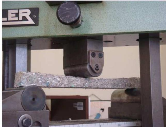
**Figura 6.9** Ensayo de flexión
