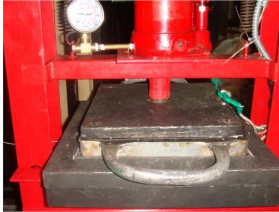
**Figura 6.3** Pre calentamiento de la mezcla
