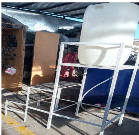
Estructura tanque principal de solución
