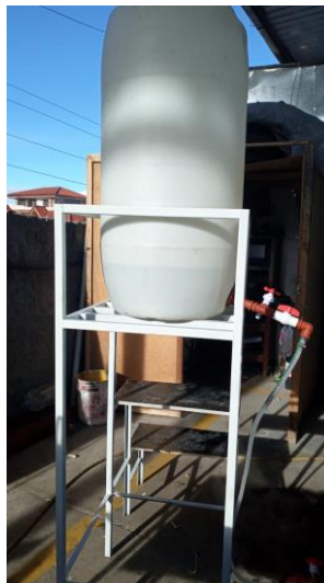
Marco estructural tanque principal de solución
