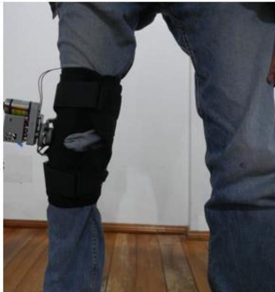
Finalmente, después de haber almacenado los datos del paciente en la base de datos se procede a colocar la órtesis en modo de asistencia para que el sistema de control se ponga en funcionamiento y la órtesis brinde soporte y apoyo a los movimientos que desea realizar el paciente.
