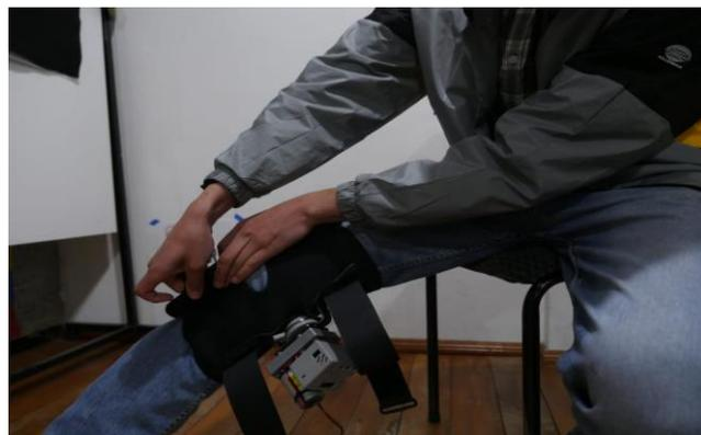
Después de que el paciente está en la posición necesaria para evaluar los parámetros necesarios para la rehabilitación se procede a colocar la órtesis en la pierna afectada, posteriormente se ajusta los velcros de la órtesis para que esta quede sujeta de la mejor manera en la articulación del paciente como se inidica en la figura 69.
