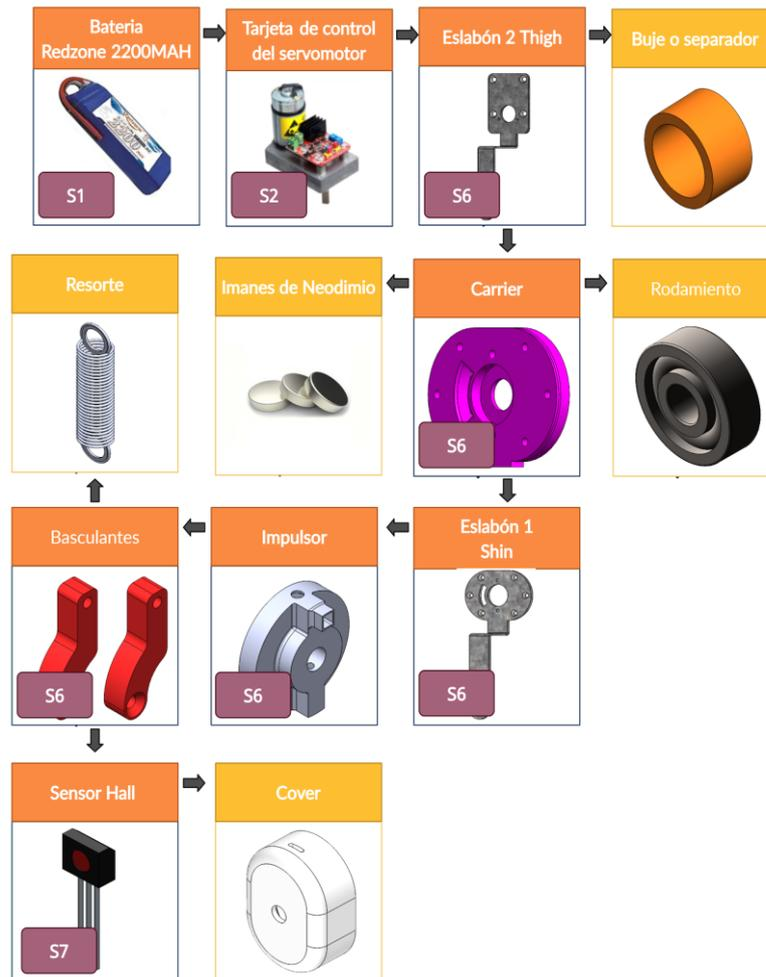
Nota: en la figura se tienen Subsistema de Control Electrónico (S3) Subsistema mecánico (S2) Unidad de medición (S6) Alimentación (S1) Sistema de Comunicación para el envío de datos (S4) Interfaz para visualización de datos (S5) [8]
