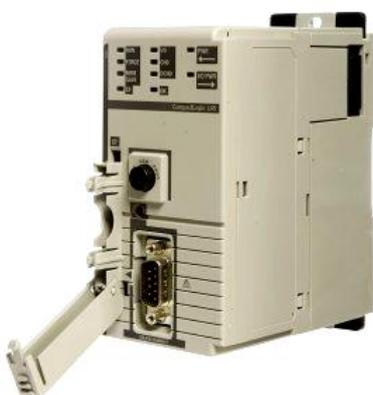
**Figura. 4.5. Módulo controlador del PLC**
