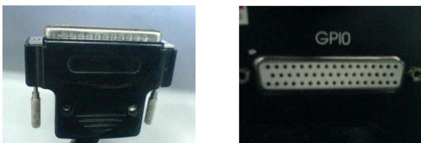
**Figura. 3.10. Conectores macho y hembra del puerto GPIO**
