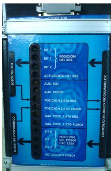
**Figura. 4.17. Convertidor de señales, bits utilizados y bits auxiliares**
