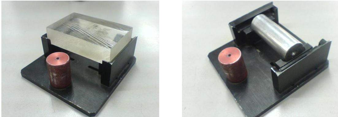
**Figura. 3.3. Prisma y Cilindro colocados en el Pallet**
