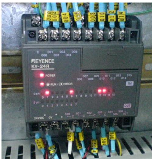
Figura. 3.9. Micro-PLC controlador del Riel
