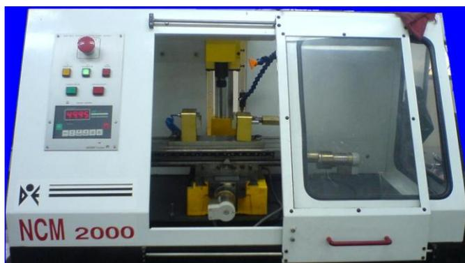
Figura. 3.7. Máquina Fresadora NCM 2000
