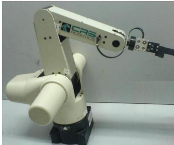
Figura. 4.8. Brazo Robótico CRS A255
