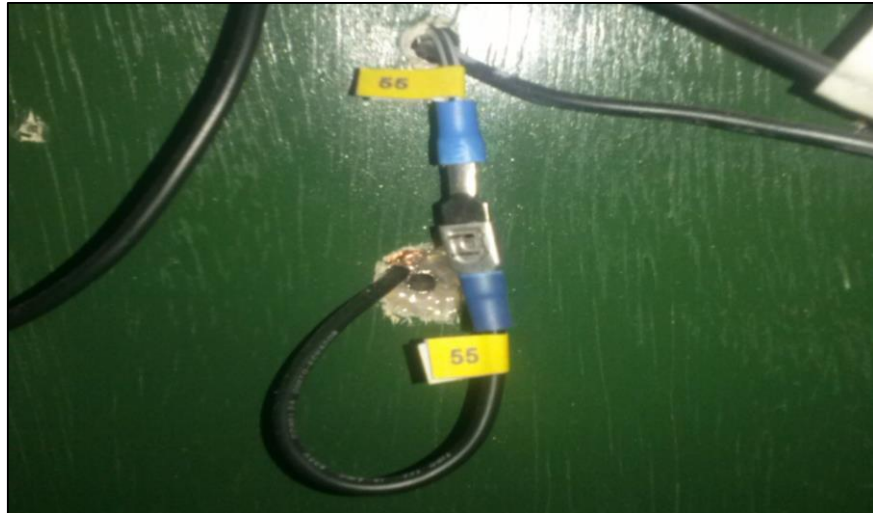
Figura 41. Averías al polo positivo de un componente
