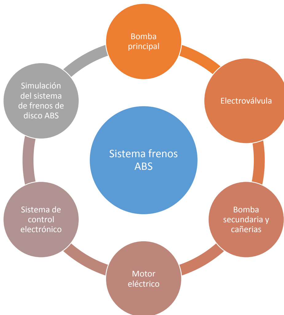
Figura 38 Diagrama de funcionamiento del sistema de frenos ABS
